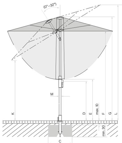
Loser Deckbelag max. 10 cm, Betondicke min. 30 cm (Frosttiefe beachten), Wasserabfluss gewährleisten.
