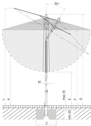
Looser Deckbelag max. 10 cm, Betondicke min. 30 cm (Frosttiefe beachten), Wasserabfluss gewährleisten.
